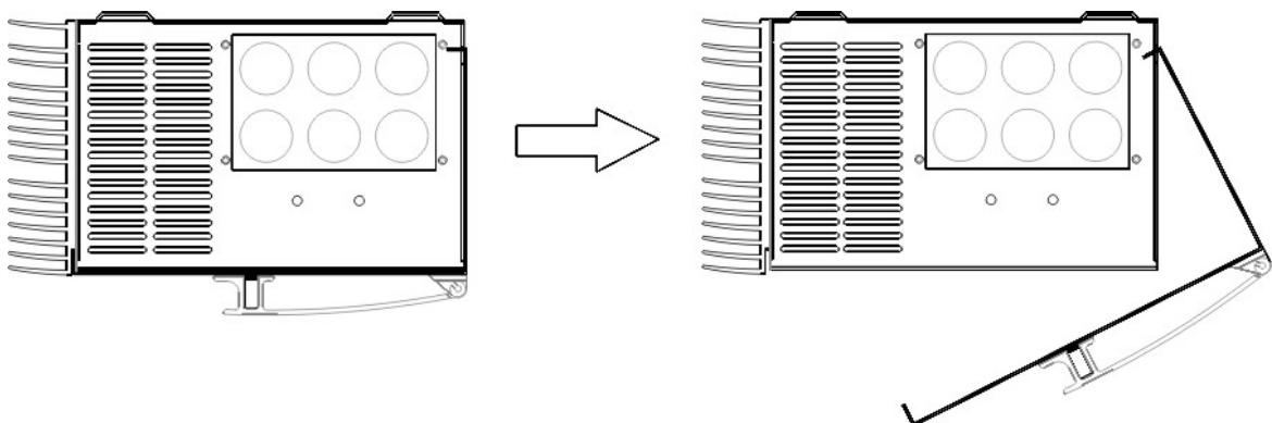
控制箱背面四个角上分别有一个固定安装孔，采用挂墙安装方式，其中上部采用  $\Phi 6$  的膨胀螺栓固定，下部采用  $\Phi 8$  塑料胀塞和螺丝固定。安装后螺丝不能超出箱底 50mm。
