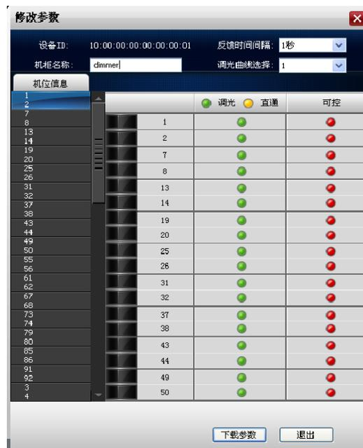
左侧的机位信息列表可以用来快速定位到需要设置的回路。单击回路号后面的“调光/直通”按钮，可切换当前回路的调光/开关（直通）工作状态；单击右侧的“可控”按钮，可以切换当前回路继电器的闭合/断开状态，修改完毕，点击“下载参数”按钮将数据下载至调光柜，将弹出如下对话框，点击“确定”按钮继续。
