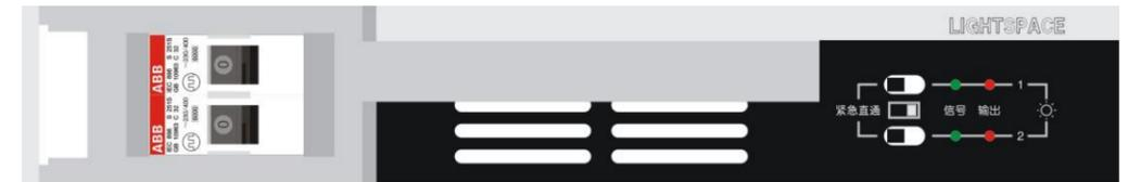
60 路调光柜共有 30 个调光插件，每个插件上有两路可控硅，面板上有两个 32A 的小型断路器，用于过载保护；每路设有信号指示灯（绿色）和输出指示灯（红色），绿色信号指示灯用于指示控制信号，红色信号指示灯并联在强电输出端。并设有紧急直通开关。
