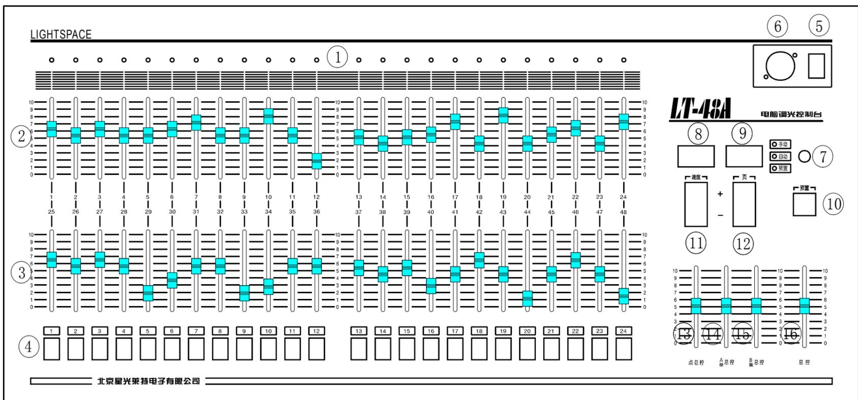
1. 光路指示灯 2. 1-24光路推杆 3. 25-48光路推杆/1-24集控推杆 4. 集控存储键/点闪键 5. DJ灯开关 6. DJ灯插座(24V)
