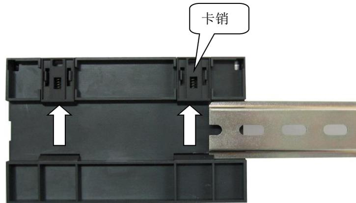
步骤 2：向内轻推模块一侧的卡销，当听到“咔嗒”一声时，卡销完全卡住导轨，模块安装到位。
