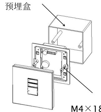
(5) 将面壳与后壳卡扣在一起。注意面壳上的插针对正后壳的插针座孔。
